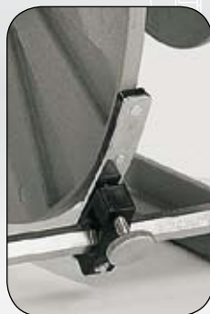
Spezialbremse Für kontrollierten Ablauf und zum Feststellen des Wickelkörpers.
